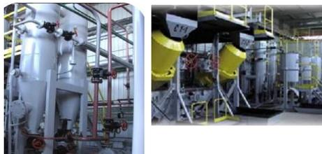
**Комплекс оборудования для очистки твердого и жидкого шлама от нефтепродукта, использующего различные гидродинамические эффекты и метод коалесценции**
